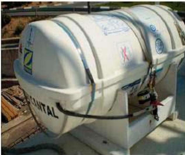
Se prestará mucha atención a la instalación correcta de los dispositivos de zafa hidrostática y a que no se instalen sistemas de trincaje adicionales que puedan impedir la liberación de la misma cuando el dispositivo actúe por el hundimiento del buque.
